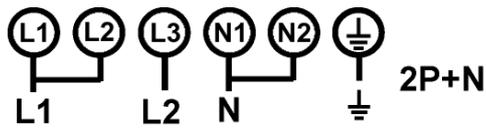
Bringen Sie eine Polbrücke zwischen Anschlussklemme L1 und L2, sowie zwischen Anschlussklemme N1 und N2 an.
