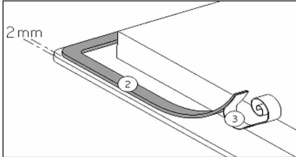
Die Dichtung (2) nach Abnehmen der Schutzfolie (3) mit 2 mm Abstand der Außenkante des Glases aufkleben.
