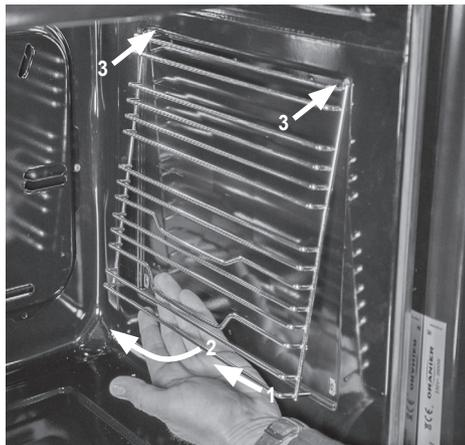
Zum Einhängen zunächst die beiden oberen Haken in die beiden Löcher der Backraumwand einhängen. Dann die Reling unten in die Halterungen einsetzen.
