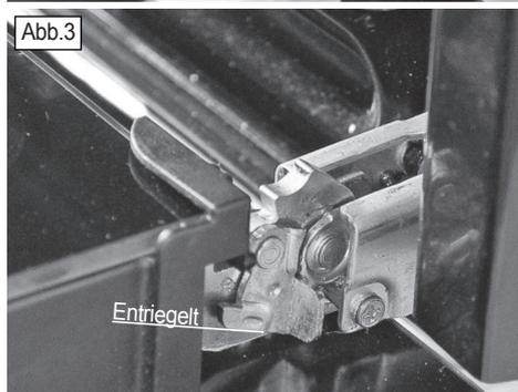
3. Die FullClear-Backraumtür an den Seiten greifen, zu etwa zwei Dritteln wieder schließen und nach oben abziehen (Abb. 4).
